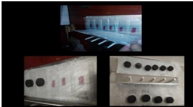
Figura 14. Los cortes se sujetan bajo la presión de un imán sobre una lámina metálica. Fuente: elaboración propia.
