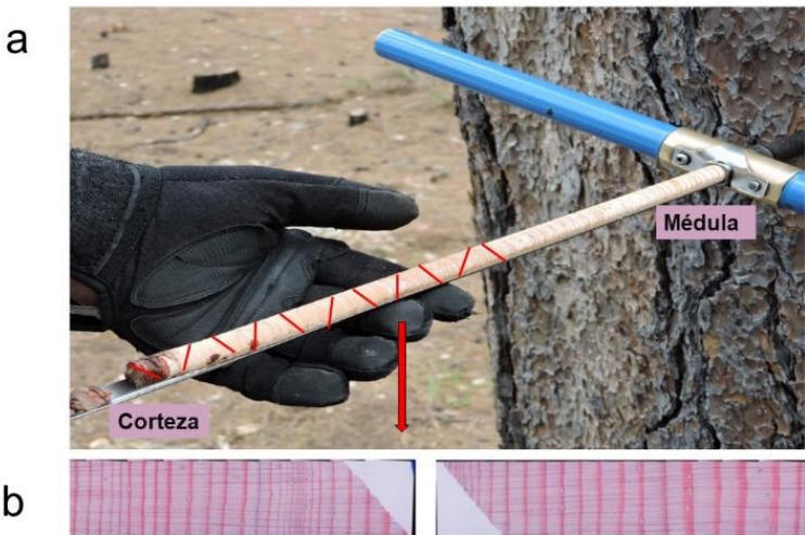
Figura 9. a) Patrón de corte diagonal: b) patrón de corte recomendado para dar continuidad cronológica al crecimiento. Fuente: (von Arx et al. , 2017).
