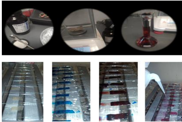
Figura 12. Tinción de la muestra con los tintes vegetales Astral Blue y safranina. Fuente: realización propia.
